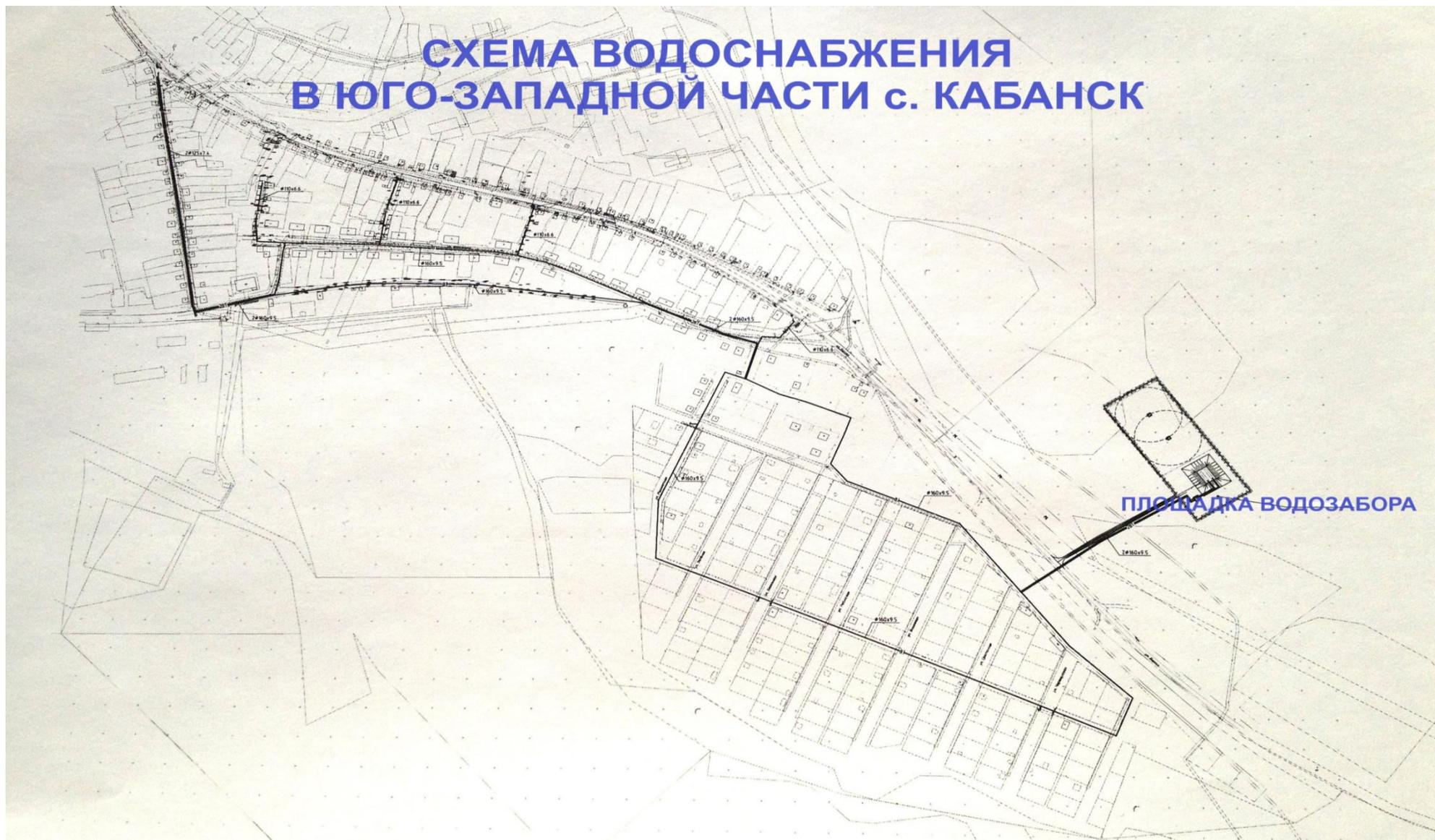
Схема проектируемых мест расположения системы водоснабжения в юго-западной части с. Кабанск
